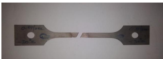
Fig 3 b) Broken Tensile test piece
