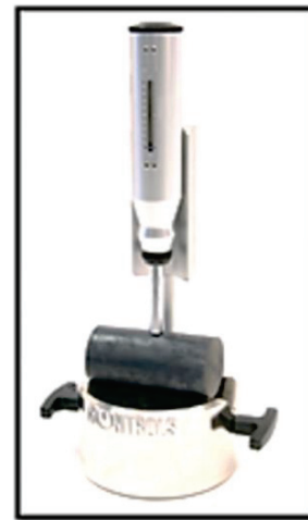
Fig. 6. Schmidt hammer test
