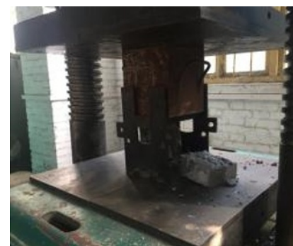
Fig. 1. Split tensile test
