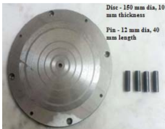
Fig. 1. AISI 301LN Specimens
