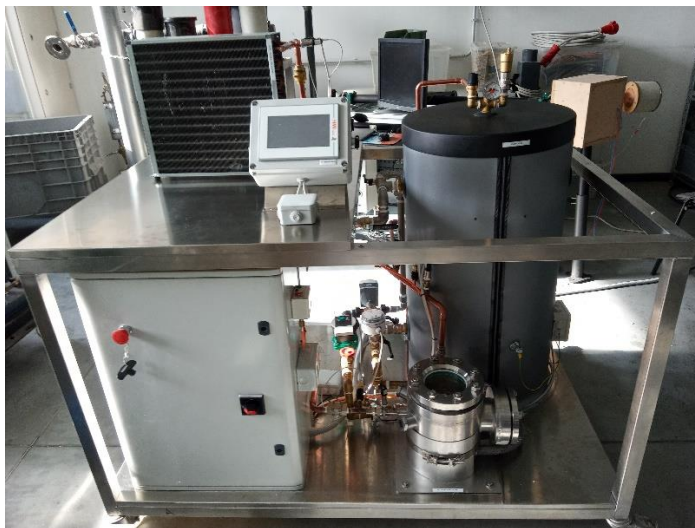
Fig. 13. Boiling test rig
