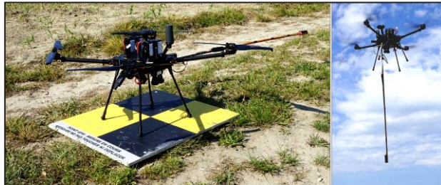
Fig.1. Système d'acquisition magnétique EASYMAG [7] intégrant un capteur magnétique à un drone conçu spécifiquement. A gauche : système au sol, la plaque jaune et noir mesure 50 cm x 50 cm. A droite : système en vol. La perche rigide mesure 1 m dans cette étude.
