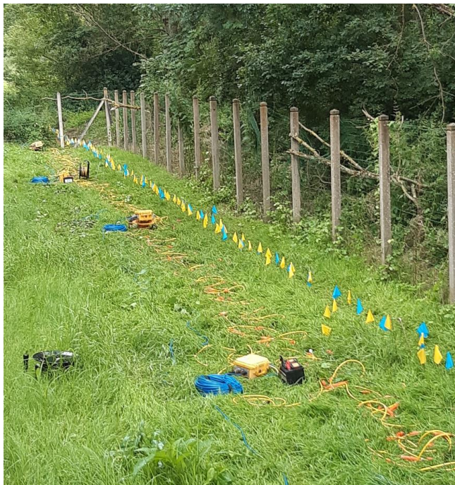
Figure 2: Dispositif d'enregistrement d'une ligne sismique
