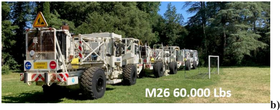
Fig. 4 : a) localisation des failles et des lignes sismiques acquises HR acquises pour caractériser les failles en profondeur. La ligne « TEST » représente le tronçon sur lequel ont été réalisés les test de calibration de la campagne. Le rectangle orange délimite l’emprise de la carte de la Figure 5. b) sources sismiques de la campagne d’acquisition sismique HR de septembre 2021 (camions M26 60.000Lbs).
