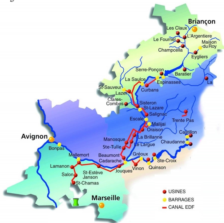
Fig. 2. Principaux aménagements EDF sur le bassin versant de la Durance.
