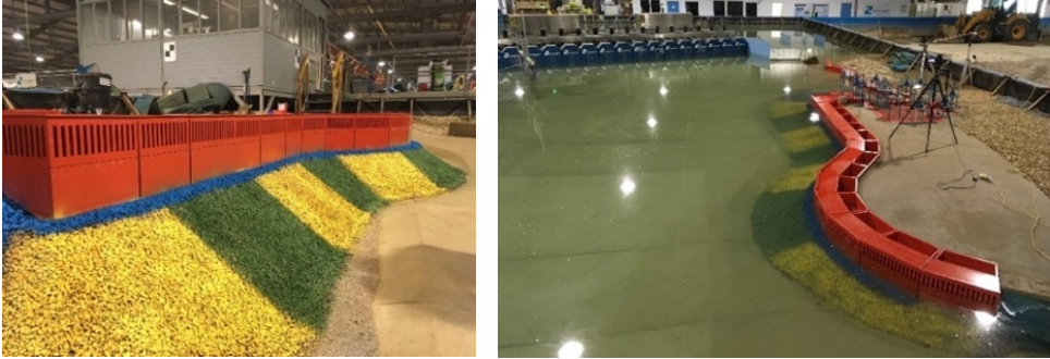
Fig. 10. Maquette 3D pour essais hydrodynamiques dans le laboratoire HR Wallingford [23].
