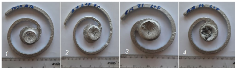
Fig. 3. Samples: 1-D16; 2- D16+ lithium fluoride 5%; 3- D16+ lithium fluoride 10%; 4- D16+ lithium fluoride 15%.
