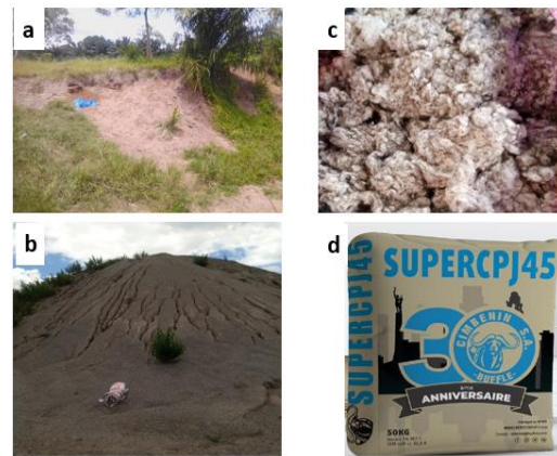
Fig. 2. Raw material (a) Dune sand (b) crushed 0/5 (c) cotton ginning waste (d) cement.
